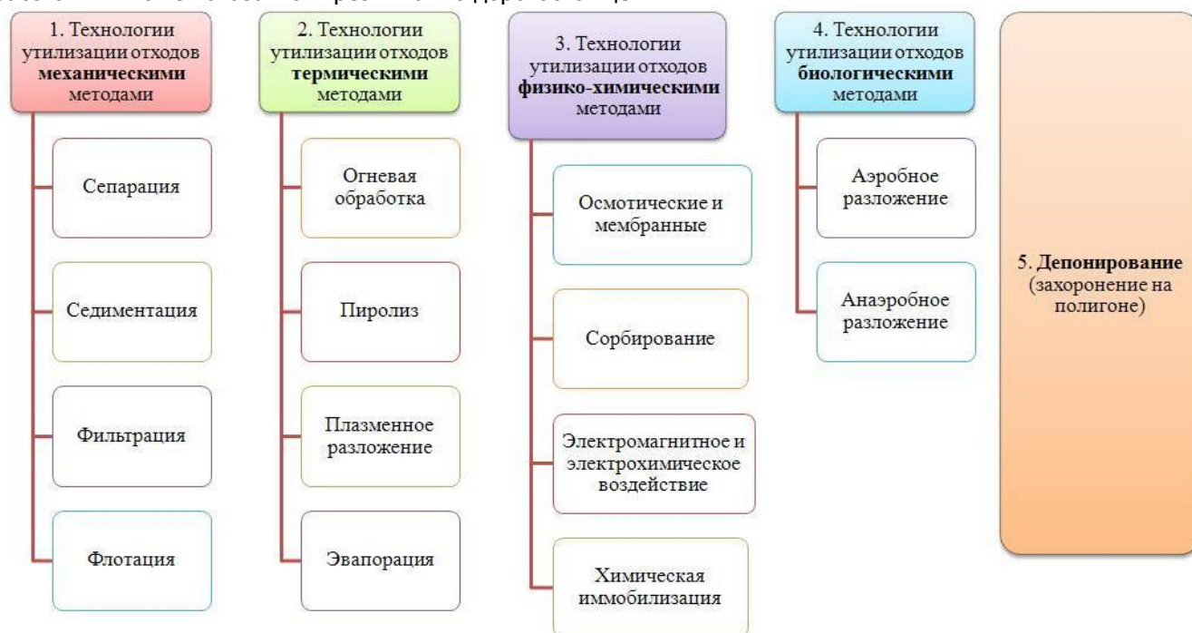
Рисунок 1.13. — Принципиальная схема-классификация известных технологий утилизации и обезвреживания опасных отходов производства и потребления [14]
